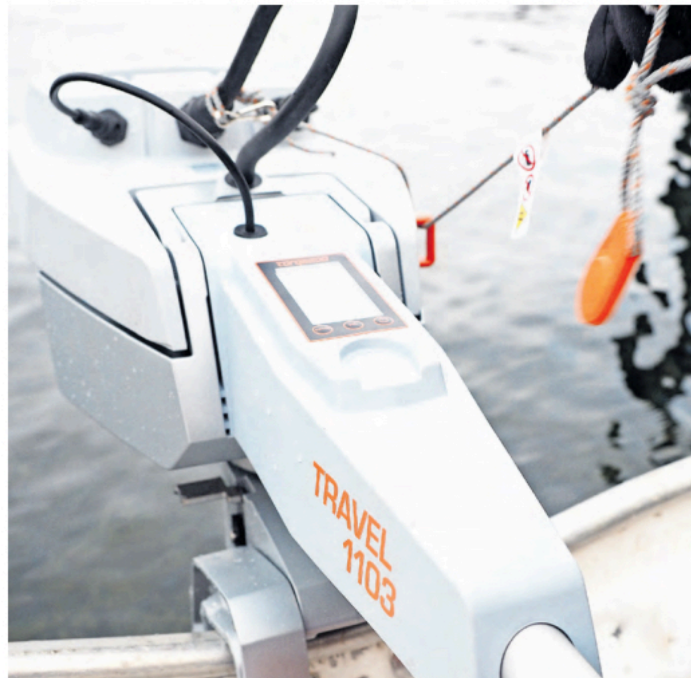
Antonio Walther und sein Sohn Nico machen in Plaun da Lej ein Ruderboot mit E-Motor für eine Testfahrt klar. Der E-Motor ist kompakt und relativ leicht. Im Notfall genügt ein Zug auf die Magnetschnur, um den E-Motor sofort auszuschalten.
