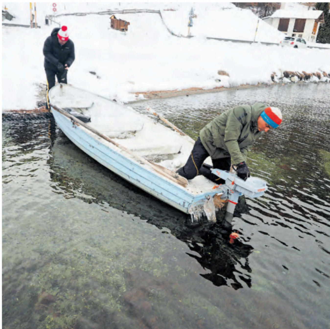
Antonio Walther und sein Sohn Nico machen in Plaun da Lej ein Ruderboot mit E-Motor für eine Testfahrt klar. Der E-Motor ist kompakt und relativ leicht. Im Notfall genügt ein Zug auf die Magnetschnur, um den E-Motor sofort auszuschalten.
