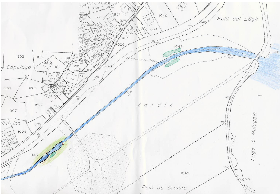
Bild 17. Bereich Capolago. Es wird vorgeschlagen einen 16 Meter langen Abschnitt oberhalb der kleinen Brücke zu renaturieren (links unten). Der Abschnitt könnte sich aber auch weiter Flussabwärts befinden.
